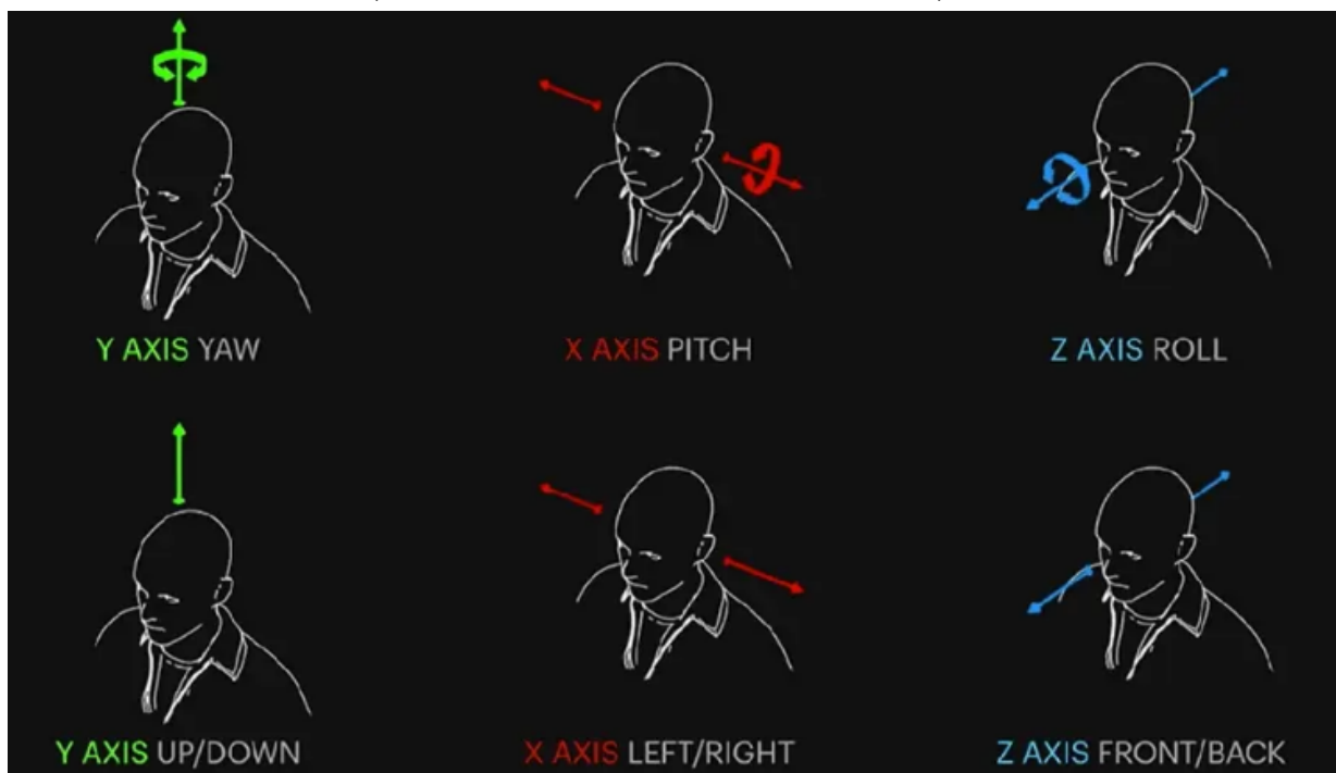
图 2 VR 头显设备的三个旋转自由度示意图
